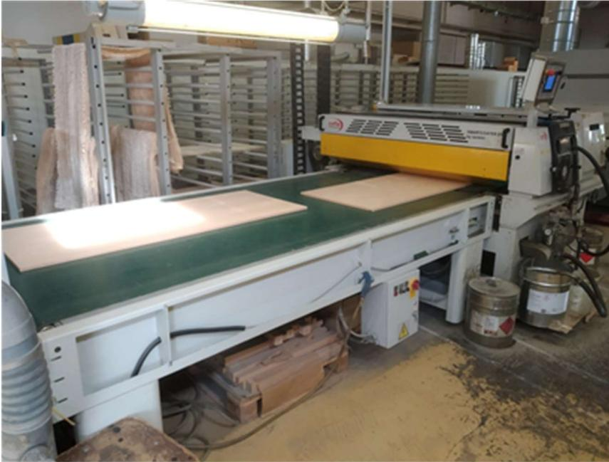
Der Lackverbrauch reduzierte sich um ein Vielfaches. Die Grundierung über Walzentechnik wird nach dem Auftrag mit UV-Licht ausgehärtet. Durch diese neue Verfahrenstechnik gibt es keine Unterbrechung im Lackierprozess.
