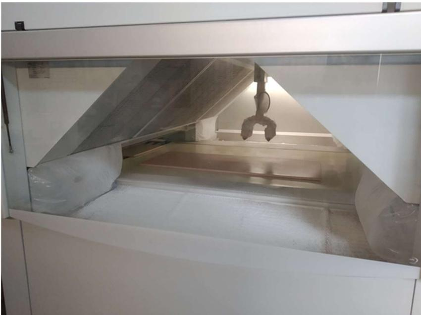
Die Schleifvorgänge vor und zwischen den Lackaufträgen werden optimal abgesaugt und führen somit zu keiner gesundheitlichen Belastung der Mitarbeiter.
